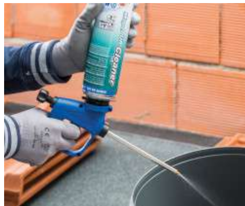
Kitöltőhab kinyomó pisztolyának tisztítása
