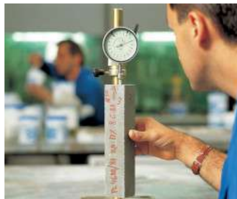
Korlátozott térfogatnövekedés mérése UNI 8147 szerint
