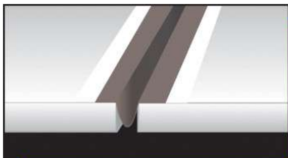
Mapeband PE 120 omega formában elhelyezése mozgási hézagban
